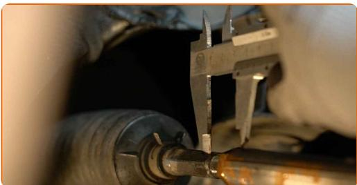
**18** Nostipriniet uzgaļa pretuzgriezni. Izmantojiet kombinēto atslēgu Nr 19. Izmantojiet dinamometrisko atslēgu. Griezes moments 44 Nm.
