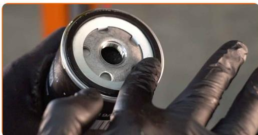
**17** Pieskrūvējiet jauno filtru tam paredzētajā vietā. Izmantojiet 76-14F uzgali. Izmantojiet dinamometrisko atslēgu. Griezes moments 18 Nm.
