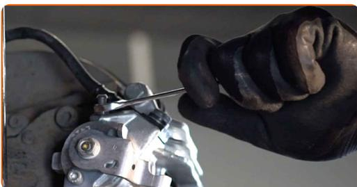
**25** Uzstādiet bremžu atgaisošanas aprīkojumu iemavu.
