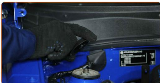
**15** Atskrūvējiet augšējo amortizatora statņa balsta stiprinājumu. Izmantojiet kombinēto atslēgu Nr 21. Izmantojiet HEX Nr. H7. Izmantojiet atslēgu ar tarkšķi.
