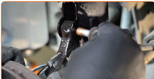
**35** Pievelciet amortizatora statnes apakšējos stiprinājumus pie grozāmass. Izmantojiet kombinēto atslēgu Nr 18. Izmantojiet mucīnatslēgu Nr 18. Izmantojiet dinamometrisko atslēgu. Griezes moments 40 Nm. +90°
