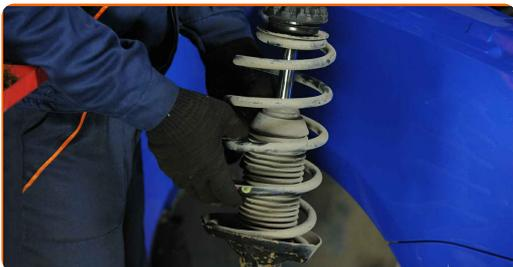
**28** Pieskrūvējiet augšējo amortizatora statņa balsta stiprinājumu.
