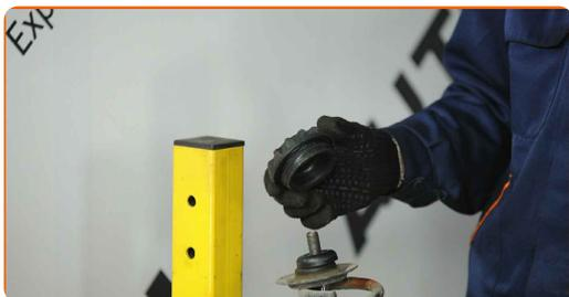
**24** Pievelciet amortizatora statņa kļauņa uzgriezni. Izmantojiet mucīņatslēgu Nr 21. Izmantojiet HEX Nr. H7. Izmantojiet dinamometrisko atslēgu. Griezes moments 60 Nm.
