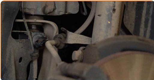
**12** Notīriet stabilizatora atsaites stiprinājumus. Izmantojiet metāla birsti. Izmantojiet WD-40 aerosolu.
