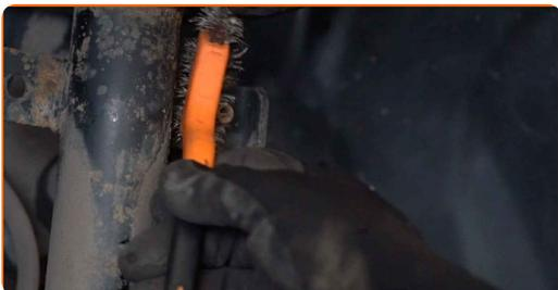
**13** Atskrūvējiet uzgriezni un noņemiet stabilizatora stiepli no amortizatora statņa. Izmantojiet HEX Nr. H6. Izmantojiet kombinēto atslēgu Nr 17.
