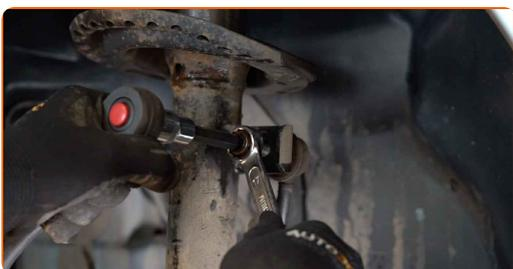
**14** Notīriet amortizatora statnes stiprinājumus pie grozāmass. Izmantojiet metāla birsti. Izmantojiet WD-40 aerosolu.
