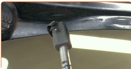
8 Notīriet bagāžas nodalījuma pārsega amortizatora montāžas sēžas. Izmantojiet WD-40 aerosolu.
