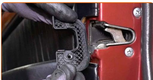
**4** Atvienojiet durvju roktura apdares paneli. Izmantojiet plastmasas apdares demontāžas instrumentu.
