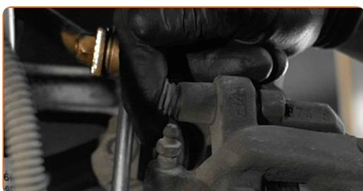
**27** Pievienojiet bremžu kluču nodiluma sensora elektroinstalācijas vadojumu.
