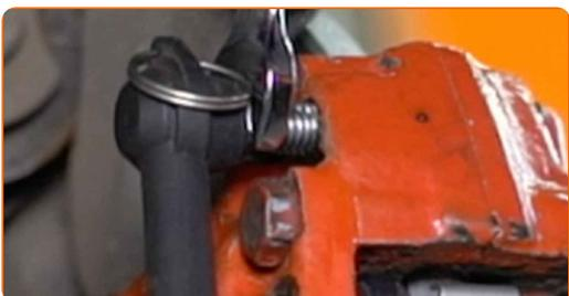
**53** Atvienojiet bremžu sistēmas atgaisošanas aprīkojumu.
