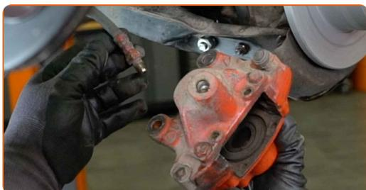
**21** Notīriet bremžu atgaisošanas skrūvi. Izmantojiet metāla birsti. Izmantojiet WD-40 aerosolu.
