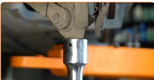
**Mainā: stabilizatora atsaites – MERCEDES-BENZ C Klase T-modell (S204).**
