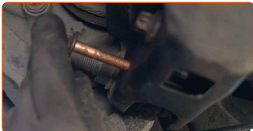
**15** Pievelciet stiprinājumu, kas savieno stabilizatora stiepi ar balstiekārtas sviru. Izmantojiet mucīnatslēgu Nr 13. Izmantojiet Torx E12. Izmantojiet dinamometrisko atslēgu. Griezes moments 20 Nm. +180°
