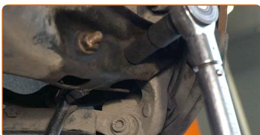
**16** Pievelciet stiprinājumu, kas savieno stabilizatora atsaiti pie stabilizatora stieņa. Izmantojiet kombinēto atslēgu Nr 17. Izmantojiet kombinēto atslēgu Nr 22. Izmantojiet dinamometrisko atslēgu. Griezes moments 50 Nm.
