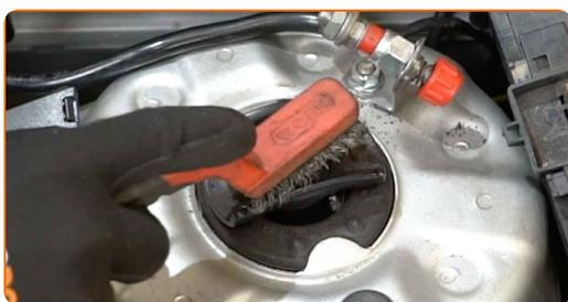
**4** Atskrūvējiet amortizatora statnes atbalstu augšējos stiprinājumus. Izmantojiet kombinēto atslēgu Nr 21. Izmantojiet HEX Nr. H7. Izmantojiet atslēgu ar tarkšķi.
