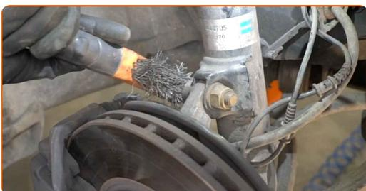
**17** Atskrūvējiet augšējo stiprinājumu, kas savieno amortizatora statni ar grozāmasi. Izmantojiet HEX Nr. H12. Izmantojiet mucīņatslēgu Nr 21. Izmantojiet atslēgu ar tarkšķi. Izmantojiet vītņurbja atslēgu.
