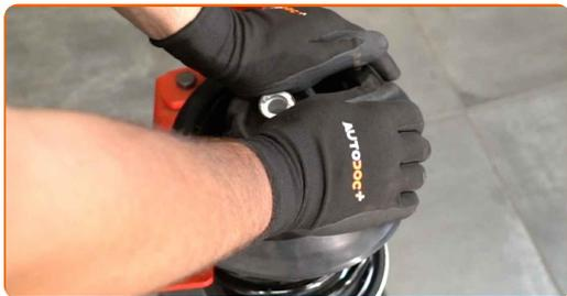
**34** Pievelciet amortizatora statņa kļauņa uzgriezni. Izmantojiet amortizatora statņa muciņu 14X2.5 mm. Izmantojiet mucīnatslēgu Nr 21. Izmantojiet HEX Nr. H6. Izmantojiet dinamometrisko atslēgu. Grieznes moments 20 Nm.
