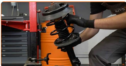
**38** Apstrādājiet amortizatora statņa montāžas sēžas. Izmantojiet metāla birsti. Izmantojiet WD-40 aerosolu.
