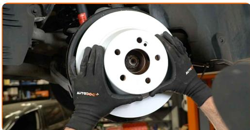
**27** Pievelciet bremžu diska stiprinājumu. Izmantojiet Torx T 30. Izmantojiet dinamometrisko atslēgu. Griezes moments 8 Nm.
