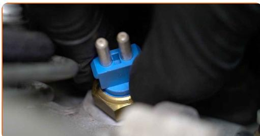
Maiņa: temperatūras sensors un dzesēšanas šķidruma termostats – MERCEDES-BENZ E Klase Platforma / Šasija (VF210). AUTODOC ekspertu padomi:
