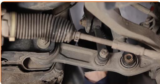
**23** Ieskrūvējeit stiprinājumu, kas savieno amortizatora dakšu ar apakšējo balstiekārtas sviru. Izmantojiet kombinēto atslēgu Nr 18. Izmantojiet mucīņatslēgu Nr 22. Izmanojiet atslēgu ar tarkšķi.
