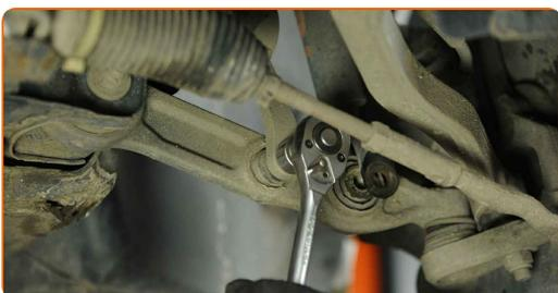
**12** Izņemiet stabilizatora atsaites stiprinājumus. Izmantojiet montāžas sviru.
