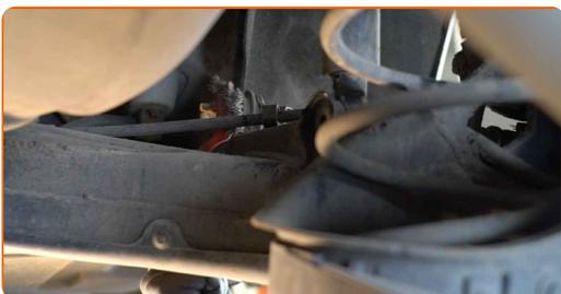
**11** Atskrūvējiet stiprinājumu, kas savieno stabilizatora stiepi ar balstiekārtas sviru. Izmantojiet mucīņatslēgu Nr 21. Izmantojiet atslēgu ar tarkšķi.
