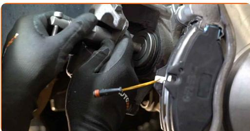
**33** Uzstādiet bremžu suportu un piestipriniet to. Izmantojiet kombinēto atslēgu Nr 17. Izmantojiet mucīņatslēgu Nr 13. Izmantojiet dinamometrisko atslēgu. Griezes moments 35 Nm.
