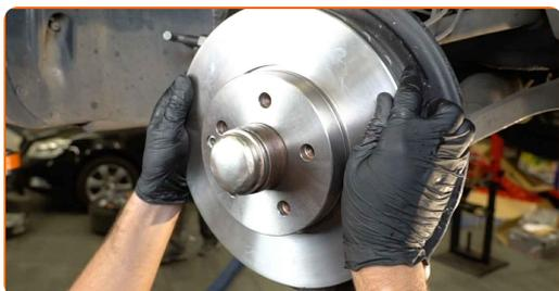
**26** Pievelciet bremžu diska stiprinājumu. Izmantojiet Torx T 30. Izmantojiet dinamometrisko atslēgu. Griezies moments 8 Nm.
