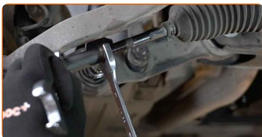
**18** Nostipriniet uzgaļa pretuzgriezni. Izmantojiet kombinēto atslēgu Nr 21 (2 gb.). Izmantojiet dinamometrisko atslēgu. Griezies moments 60 Nm.
