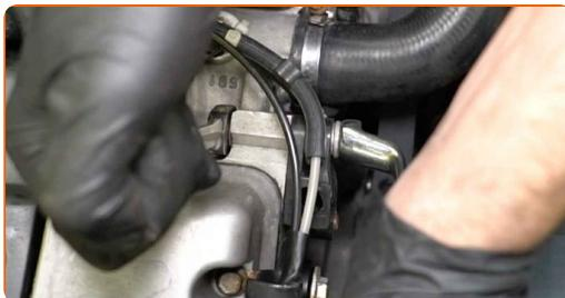
**4** Izmantojiet pareiza diametra sviru, lai atbrīvotu spriegotāju un noņemtu stiprinājuma skrūvi. Izmantojiet 3/8" gala atslēgas pagarinājumu.
