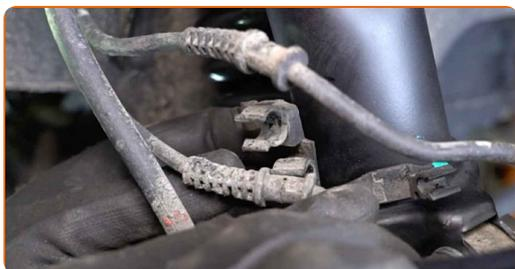
**46** Uzstādiet stabilizatora bukšu kronšteinus. Izmantojiet santehnikas kņabiles.
