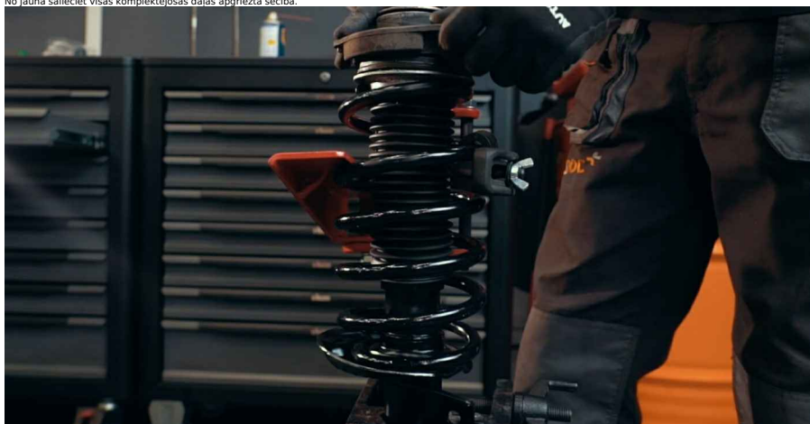
Svarīgi! • Pievērsiet uzmanību statņa balsta pozīcijai, lai nodrošinātu, ka tas ir vērsts pareizajā virzienā
