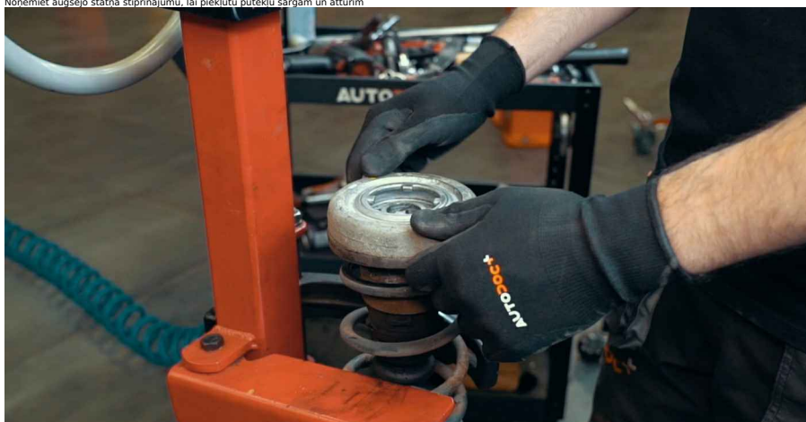
Pievērsiet uzmanību! • Atturis var būt uzstādīts uz virzuļa kāta vai piestiprināts pie balsta • Putekļu sargs var būt nofiksēts uz attura, uzstādīts starp atsperi un balstu vai piestiprināts pie balsta.
