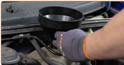
**35** Ielejiet dzesēšanas šķidrumu dzesēšanas šķidruma rezervuārā.
