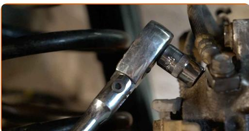
**39** Uzstādiet bremžu atgaisošanas aprīkojumu iemavu.
