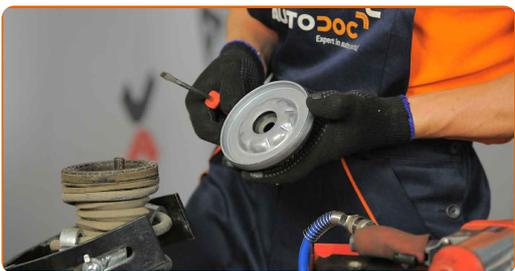
**28** Pievelciet amortizatora statņa kļauņa uzgriezni. Izmantojiet mucīnatslēgu Nr 21. Izmantojiet dinamometrisko atslēgu. Griezes moments 65 Nm.
