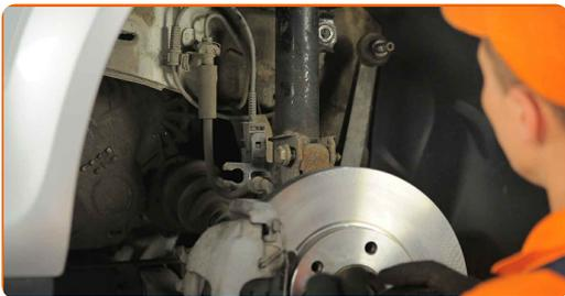
**41** Pievelciet amortizatora statnes apakšējos stiprinājumus pie grozāmass. Izmantojiet kombinēto atslēgu Nr 18. Izmantojiet mucīņatslēgu Nr 18. Izmantojiet dinamometrisko atslēgu. Griezes moments 85 Nm. +90°
