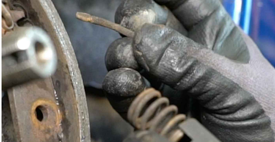
17 Atvienojiet bremžu loku no apakšējās atsperes.
