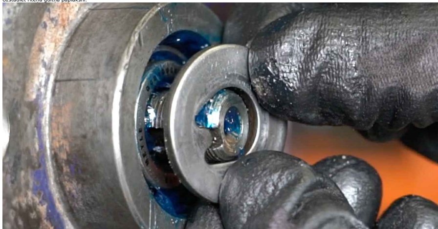
46 Uzskrūvējiet riteņa rumbas uzgriezni. Izmantojiet mucinatslēgu Nr 24. Izmantojiet atslēgu ar tarkšķi.
