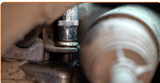
**15** Pieskrūvējiet stabilizatora bukšu kronšteinu stiprinājumus. Izmantojiet mucīņatslēgu Nr E12. Izmantojiet dinamometrisko atslēgu. Griezies moments 35 Nm.
