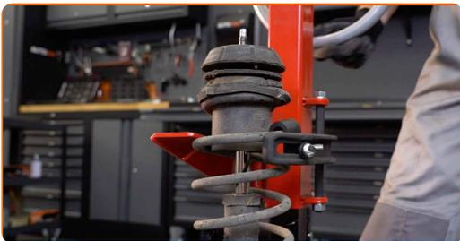
25 Atskrūvējiet amortizatora statnes virzuļa uzgriezni. Izmantojiet mucīņatslēgu Nr 19. Izmantojiet amortizatora mucīņu atslēgu DDN#8. Izmantojiet atslēgu ar tarkšķī.
