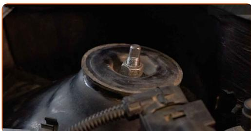
**4** Apstrādājiet amortizatora statnes kātu. Izmantojiet metāla birsti. Izmantojiet WD-40 aerosolu.
