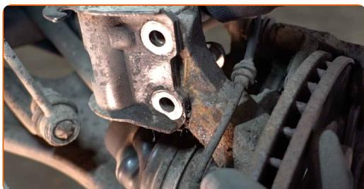
**20** Atvienojiet grozāmasi no amortizatora statņa. Izmantojiet montāžas sviru.
