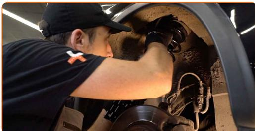
**38** Pieskrūvējiet augšējo amortizatora statņa balsta stiprinājumu. Nepievelciet to.
