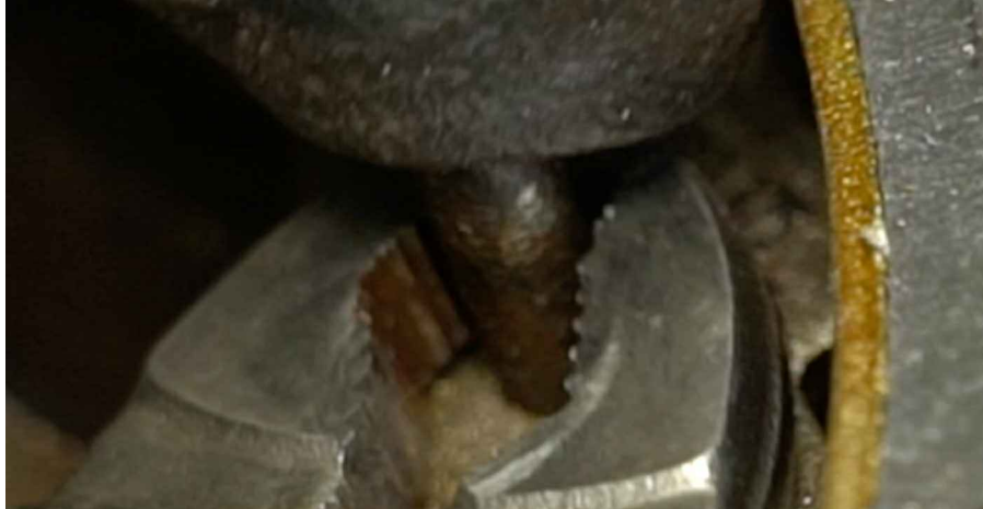
33 Uzstādiet bremžu loku regulēšanas sviru.
