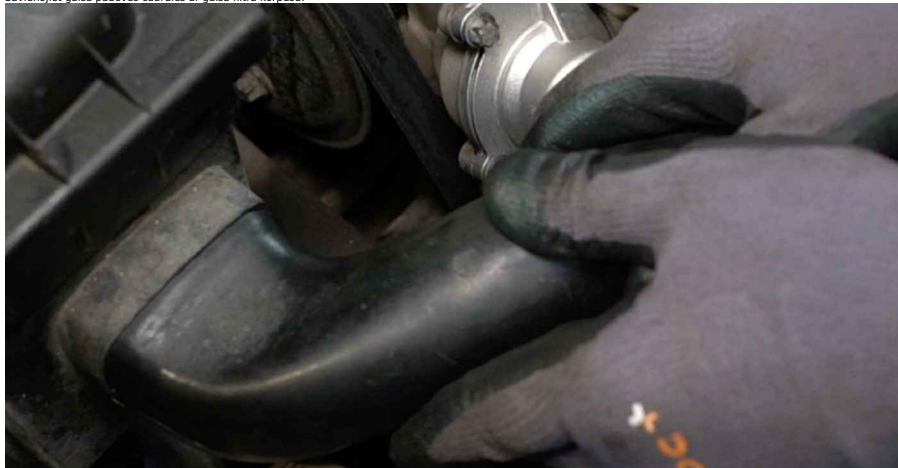
32 Pievienojiet skavu gaisa filtra iepildes šļūteni.
