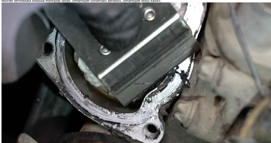
25 Uzstādiēt jauno termostata korpusu kopā ar termostatu.
