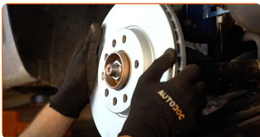
**21** Pievelciet bremžu diska stiprinājumu. Izmantojiet HEX Nr. H5. Izmantojiet dinamometrisko atslēgu. Griezes moments 7 Nm.
