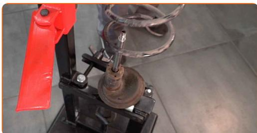
42 Noņemiet veco amortizatoru no hidrauliskā atsperu saspiedēja.
