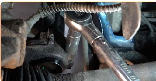
**66** Uztādiet šķērsstabilizatora stiepi. Izmantojiet mucīņatslēgu Nr 16.
