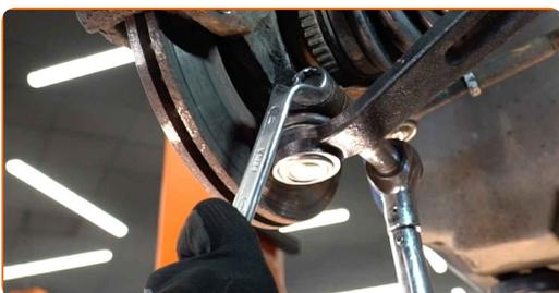
**65** Pievelciet amortizatora statnes apakšējos stiprinājumus pie grozāmass. Izmantojiet mucīņatslēgu Nr 18. Izmantojiet dinamometrisko atslēgu. Griezies moments 55 Nm.
