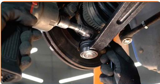
**64** Pievelciet lodbalsta stiprinājumu. Izmantojiet mucīņatslēgu Nr 17. Izmantojiet kombinēto atslēgu Nr 17. Izmantojiet dinamometrisko atslēgu. Griezies moments 40 Nm.
