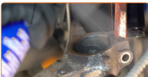
**54** Nostipriniet amortizatora statni uz grozāmass.
