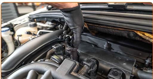
**8** Izmantojot elektrokontaktu aerosolu, apstrādājiet aizdedzes spoles kontaktligzdu. Aerosols pasargās elektrokontaktus no korozijas, oksidācijas, kā arī samazinās kontaktu pretestību.
