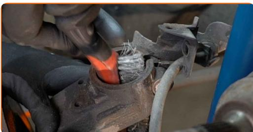
**59** Nostipriniet amortizatora statni uz grozāmass.
