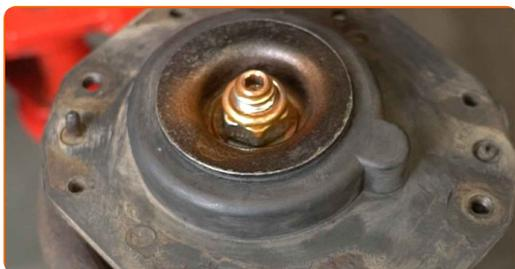
**55** Notīriet amortizatora statnes montāžas vietas. Izmantojiet metāla birsti. Izmantojiet WD-40 aerosolu.
