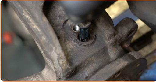
53 Pievelciet stiprinājumu, kas savieno ABS sensoru ar grozāmo statni. Izmantojiet mucīnatslēgu Nr 13. Izmantojiet dinamometrisko atslēgu. Griezes moments 10 Nm.
