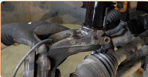
56 Nostipriniet amortizatora statni uz grozāmass.
