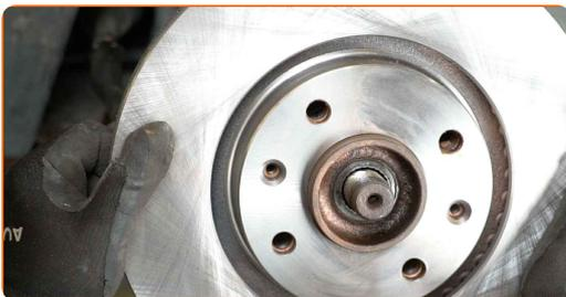
25 Atskrūvējiet uzgaļa stiprinājuma uzgriezni pie grozāmass. Izmantojiet mucīņatslēgu Nr 17. Izmantojiet atslēgu ar tarkšķī.
