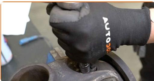
54 Apstrādājiet amortizatora statnes montāžas vietu uz grozāmass. Izmantojiet metāla birsti. Izmantojiet WD-40 aerosolu.
