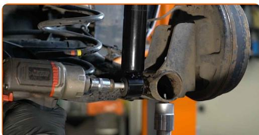
**18** Paceliet hidraulisko statni par 10-15 cm.
