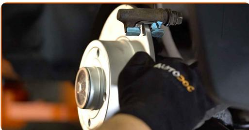
**14** Iespiediet bremžu suporta virzuli. Izmantojiet suporta bremžu cilindru izspiešanas aprīkojumu.
