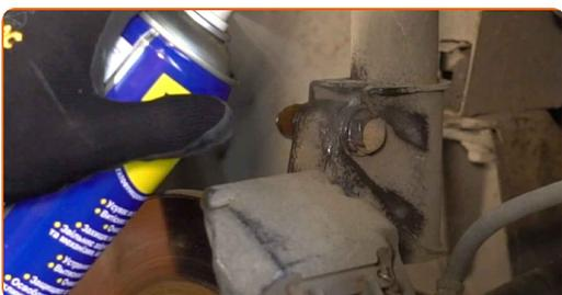
**12** Atskrūvējiet amortizatora statnes apakšējos stiprinājumus pie grozāmass. Izmantojiet kombinēto atslēgu Nr 18. Izmantojiet mucīnatslēgu Nr 18. Izmantojiet vīturbja atslēgu.
