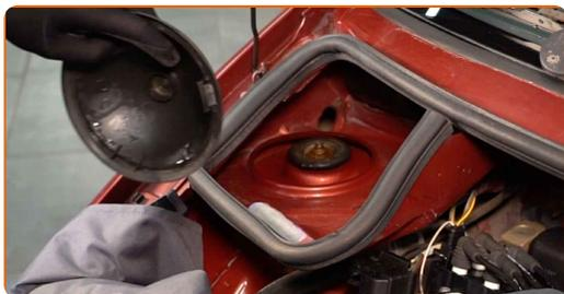
**4** Notīriet amortizatora statnes augšējā balsta stiprinājumus. Izmantojiet metāla birsti. Izmantojiet WD-40 aerosolu.
