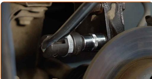
**13** Paceliet grozāmasi. Izmantojiet hidraulisko transmisiju domkratu.
