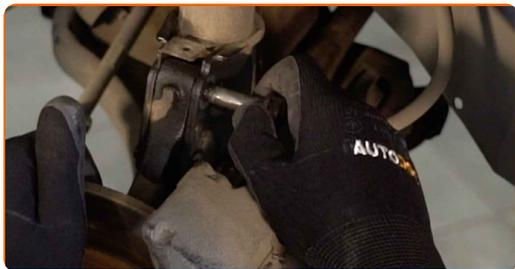
**15** Atvienojiet grozāmasi no amortizatora statņa. Izmantojiet montāžas sviru.
