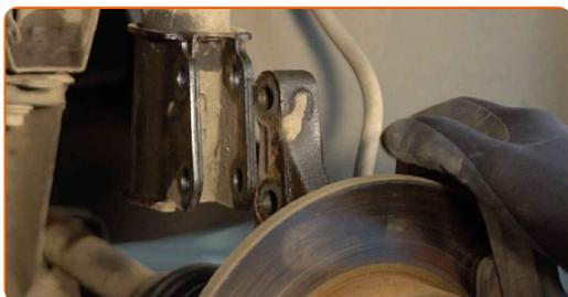
**16** Atskrūvējiet augšējo amortizatora statņa balsta stiprinājumu. Izmantojiet mucīņatslēgu Nr 21.
