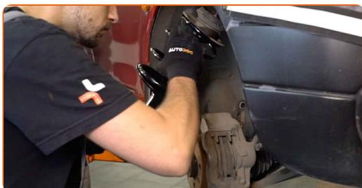
**36** Pieskrūvējiet augšējo amortizatora statņa balsta stiprinājumu. Nepievelciet to.
