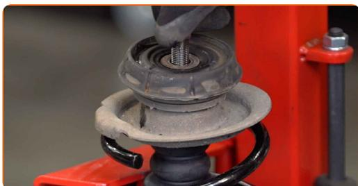
32 Pievelciet amortizatora statņa klaņa uzgriezni. Izmantojiet mucīnatslēgu Nr 17. Izmantojiet HEX Nr. H6. Izmantojiet dinamometrisko atslēgu. Griezies moments 25 Nm.
