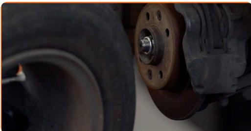
**11** Notīriet amortizatora statnes stiprinājumus pie grozāmass. Izmantojiet metāla birsti. Izmantojiet WD-40 aerosolu.
