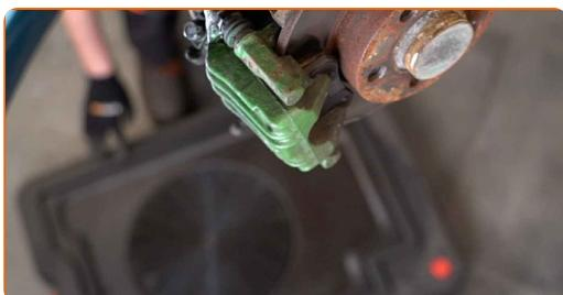
12 Atskrūvējiet bremžu šķūteni no bremžu suporta. Izmantojiet muciņatslēgu Nr 13. Izmanojiet atslēgu ar tarkšķi.
