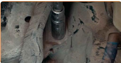
**75** Pievelciet stiprinājumus, kas savieno pārnesumkārbas balstu ar pārnesumkārbu. Izmantojiet mucīņatslēgu Nr 18. Izmantojiet dinamometrisko atslēgu. Griezes moments 69 Nm.
