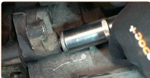
**68** Pievelciet stiprinājumus, kas savieno pārnesumkārbu ar cilindru bloku. Izmantojiet mucīņatslēgu Nr 18. Izmantojiet dinamometrisko atslēgu. Griezes moments 64 Nm.
