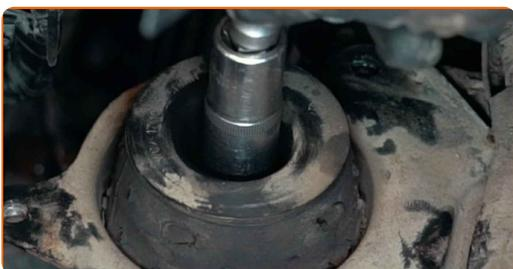
**74** Pievelciet stiprinājumus, kas savieno pārnesumkārbas balstu ar automašīnas virsbūvi. Izmantojiet mucīņatslēgu Nr 13. Izmantojiet dinamometrisko atslēgu. Griezes moments 38 Nm.
