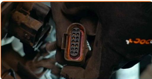
**11** Atvienojiet motora elektroinstalācijas mezglu.
