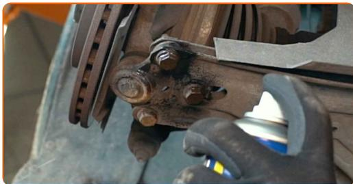
**26** Atskrūvējiet stiprinājumu, kas savieno lodbalsta savienojumu ar balstiekārtas sviru. Izmantojiet mucīņatslēgu Nr 13. Izmantojiet atslēgu ar tarkšķi.
