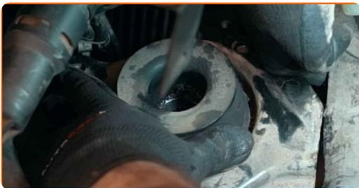
**73** Pieskrūvējiet stiprinājumus, kas savieno pārnesumkārbas balstu ar automašīnas virsbūvi. Izmantojiet mucīņatslēgu Nr 18. Izmantojiet atslēgu ar tarkšķī.
