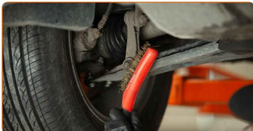
3 Atskrūvējiet stabilizatora atsaites stiprinājumus pie stabilizatora stieņa un piekares sviras. Izmantojiet kombinēto atslēgu Nr 16. Izmantojiet dinamometrisko atslēgu.
