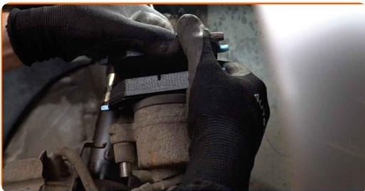
22 Uzstādiet bremžu suportu un piestipriniet to. Izmantojiet HEX Nr. H7. Izmantojiet dinamometrisko atslēgu. Griezes moments 30 Nm.
