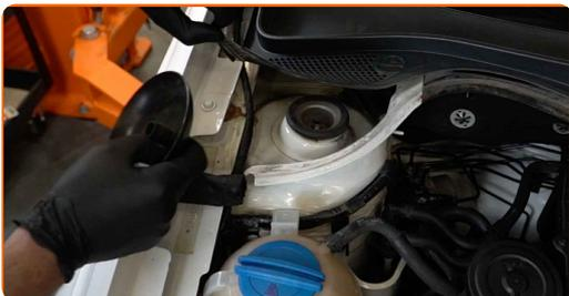
**6** Notīriet amortizatora statnes augšējā balsta stiprinājumus. Izmantojiet metāla birsti. Izmantojiet WD-40 aerosolu.
