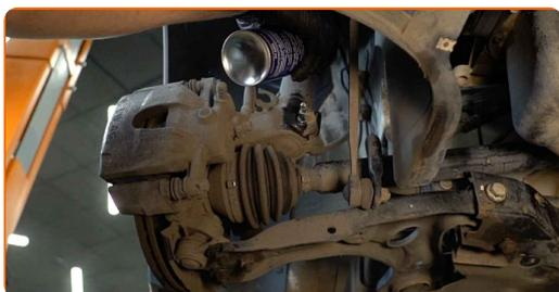
**19** Atskrūvējiet amortizatora statnes apakšējos stiprinājumus pie grozāmass. Izmantojiet XZN Nr. 14. Izmantojiet mucīņatslēgu Nr 18. Izmantojiet vītņurbja atslēgu. Izmantojiet atslēgu ar tarkšķi.
