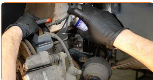
**52** Nostipriniet amortizatora statni uz grozāmass.
