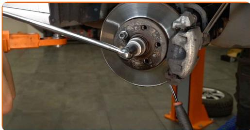
**18** Notīriet amortizatora statnes stiprinājumus pie grozāmass. Izmantojiet metāla birsti. Izmantojiet WD-40 aerosolu.
