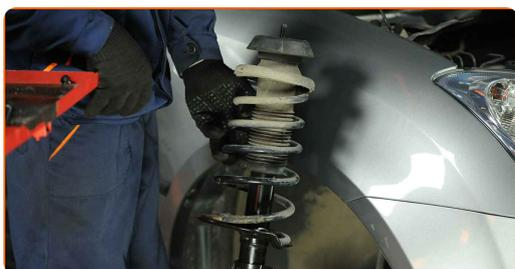
**44** Pieskrūvējiet augšējo amortizatora statņa balsta stiprinājumu.
