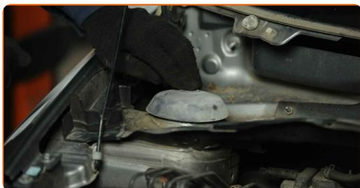
**47** Uzstādiet un nostipriniet loga tīrītāja pārsega režģi, kas atrodas labajā pusē.
