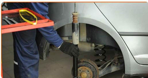
23 Notīriet amortizatora montāžas sēžas. Izmantojiet metāla birsti. Izmantojiet WD-40 aerosolu.
