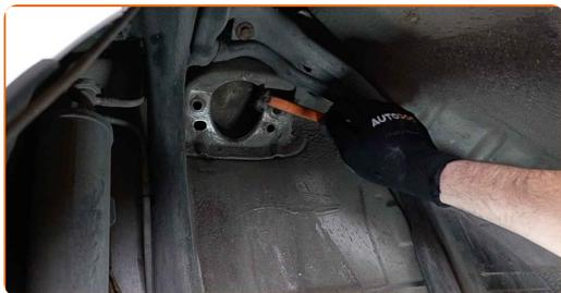
24 Ievietojiet amortizatoru riteņa arkā un nostipriniet to.
