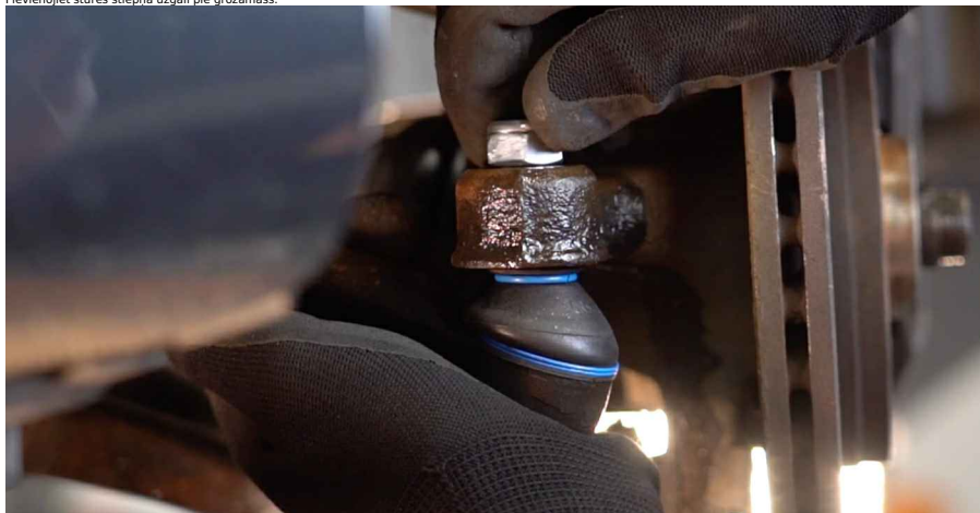
18 Pievelciet stūres stieņa uzgala stiprinājuma uzgriezni pie grozāmass. Izmantojiet mucinātslēgu Nr 17. Izmantojiet dinamometrisko atslēgu. Griezes moments 33 Nm.
