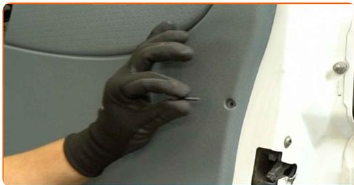
**5** Atvienojiet durvju paneli. Izmantojiet salona apdares noņemšanas instrumentu.
