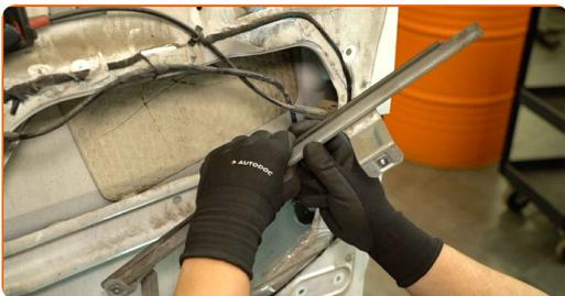
**11** Atskrūvējiet durvju slēdzenes stiprinājumus. Izmantojiet Torx uzgali T30. Izmantojiet elektrisko vai sprūdrata skrūvgriezi.
