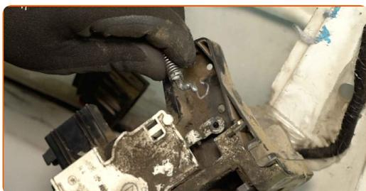
**16** Apstrādājiet durvju slēdzenes savienotāju. Izmantojiet elektronikas aerosolu.
