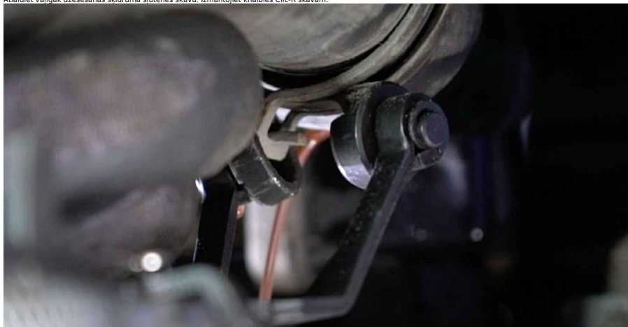
8 Atvienojiet dzesēšanas šķidruma šļūteni.
