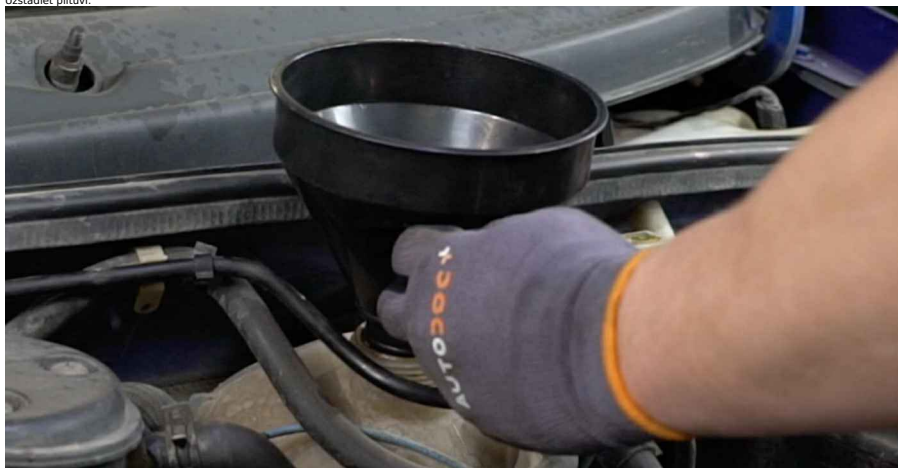
35 Ielejiet dzesēšanas šķidrumu dzesēšanas šķidruma rezervuārā.
