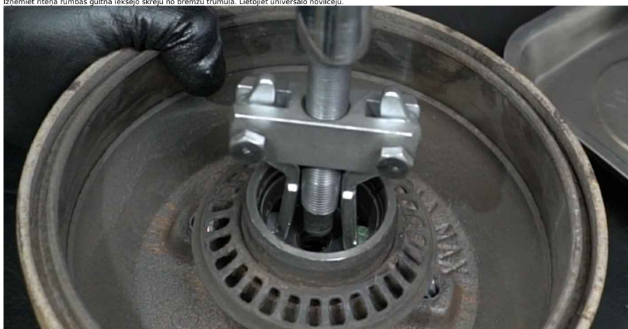
club.autodoc.lv 6-14 16 Nonemiet riteņa gultņa ārējo skreju no bremžu trumšuļa. Izmantojiet komplektu gultņu iepresēšanai un izpresēšanai.
