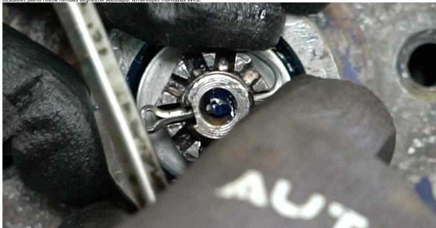
34 Uzstādiet rumbas uzgriežņa vāciņu. Izmantojiet gumijas āmuru.
