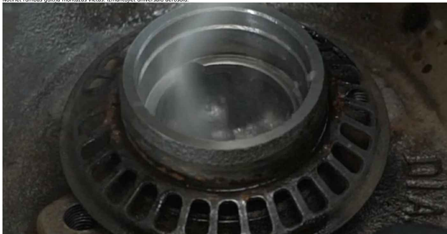
18 Uzstādiet jauno riteņa gultņa ārējo skreju bremžu trumulī. Komplekts gultņu lepresēšanai un izpresēšanai.
