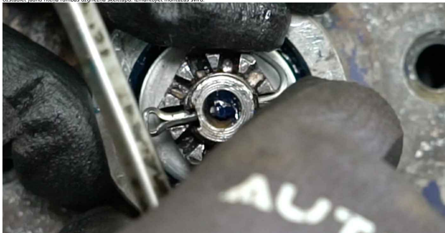
34 Uzstādiet rumbas uzgriežņa vāciņu. Izmantojiet gumijas āmuru.
