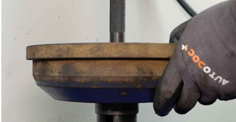
17 Notīriet rumbas gultņa montāžas vietas. Izmantojiet universālu aerosolu.
