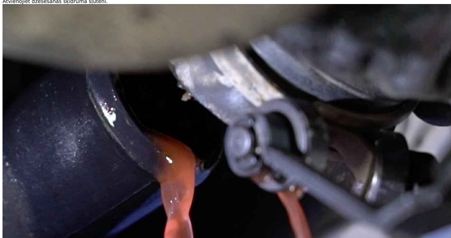
8 Atvienojiet dzesēšanas šķidruma šļūteni.
