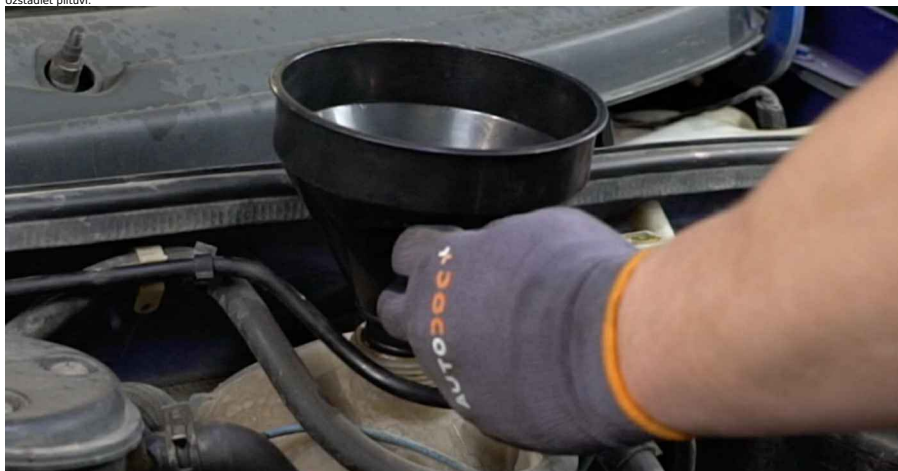
35 Ielejiet dzesēšanas šķidrumu dzesēšanas šķidruma rezervuārā.
