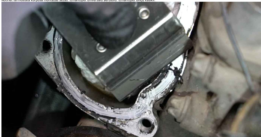
25 Uzstādiēt jauno termostata korpusu kopā ar termostatu.
