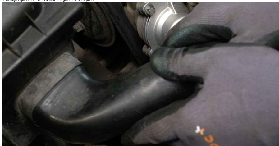
32 Pievienojiet skavu gaisa filtra iepildes šļūteni.
