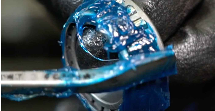
21 Uzstādiet jaunu ritena rumbas gultni un nostipriniet to.
