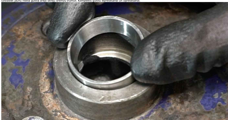
19 Uzstādiet jauno riteņa rumbas gultņa iekšējo skreju bremžu trumulī. Komplekts gultņu lepresēšanai un izpresēšanai.
