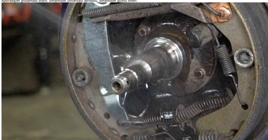
24 Uzstādiet bremžu trumulī, kas samontēts ar ritena rumbas gultni.
