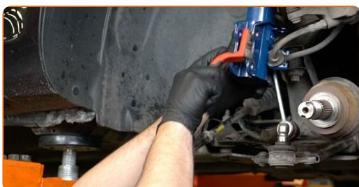
**50** Nostipriniet amortizatora statni uz grozāmass.
